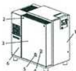
Рис. VII-48 Корпус компрессора: 1 – дверь распределительного шкафа; 2 – задвижка; 3 – часть обшивки (вставная модель); 4 – смотровой глазок указателя уровня масла; 5 – смотровой глазок натяжения ремней; шкаф с холодоосушителем
